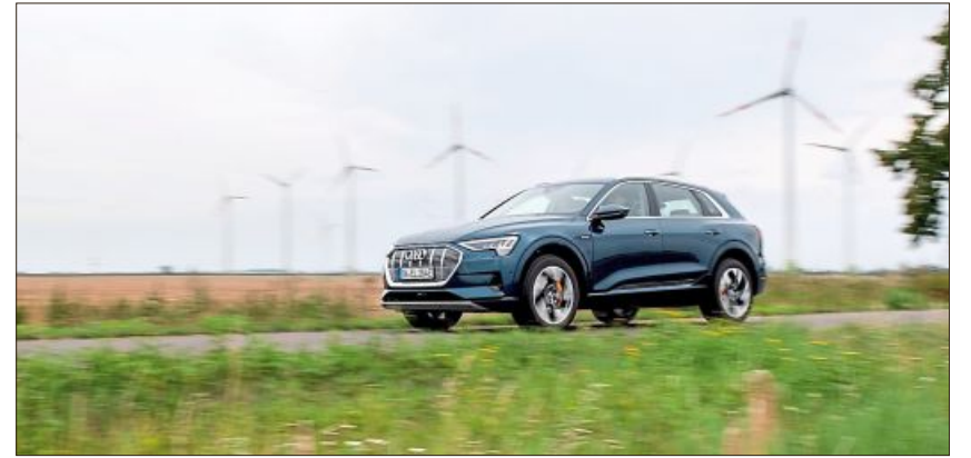
Bei der Rekuperation wird Bewegungsenergie zurück in elektrische Energie umgewandelt und im Akku gespeichert. Foto: Zacharie Scheurer/dpa-tmn
